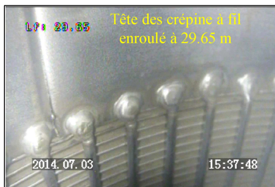
Exemple de rendu d'une inspection caméra de forage
